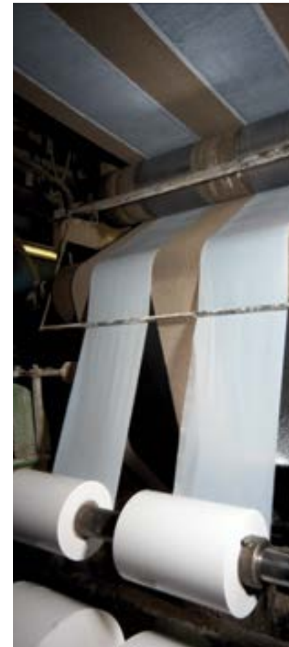
Pakkenakkumise vastase kile kandmine bituumensindli rullile enne lahtilõikamist
